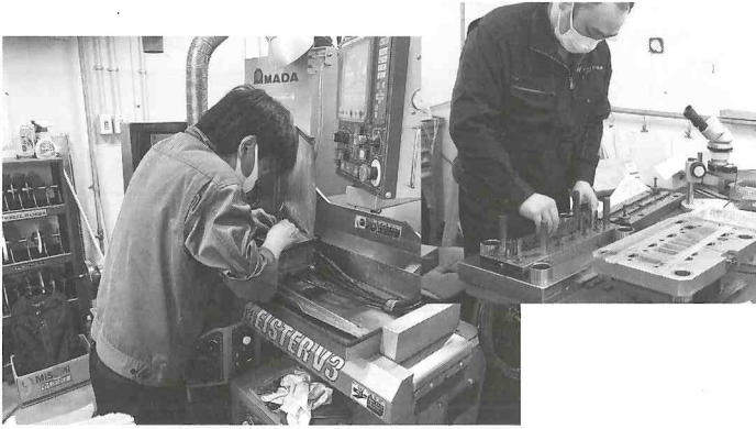
左：成型研削作業 右：金型調整作業
