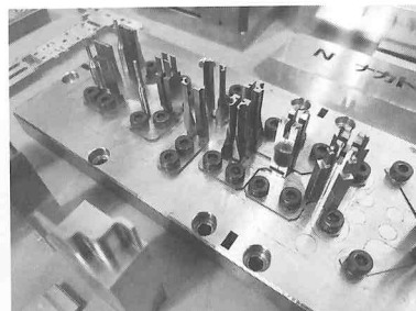
試作型モジュール（標準ダイセット用） *特許取得済
